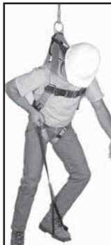
Inserte el pie dentro del orificio y ajuste.
